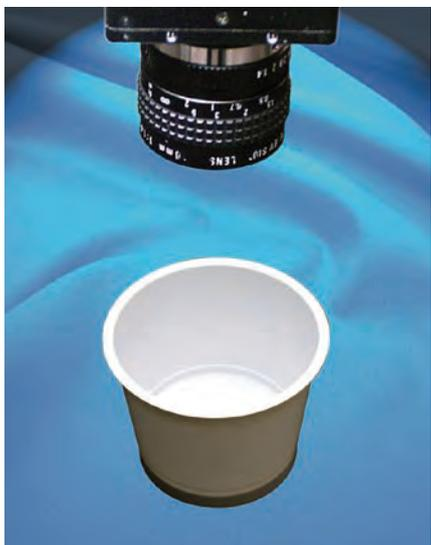
形成時、充填時、外観印刷時の内面異物欠陥を検査
