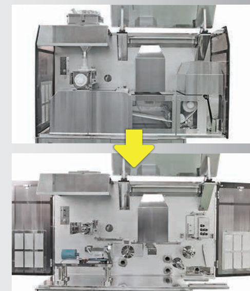
搬送部のほとんどの箇所を工具レスで分解できるので清掃が簡単!
