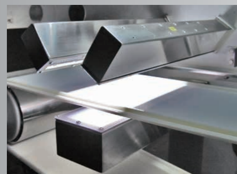
高輝度白色LEDストロボと搬送ベルト
